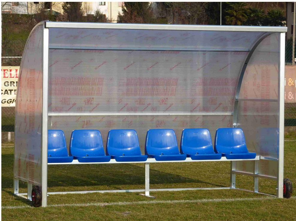
Panchina allenatori/staff-tecnico mobile su ruote, costruita totalmente in alluminio, montanti frontali a sezione maggiorata antinfortunistica 60x70 mm., telaio sezione 50x30 mm. e traversini 30x30 mm.. Copertura in policarbonato alveolare spessore 4 mm.. Completa di ruote gommate adatte anche per il trasporto nell'erba. Modulo da 3 metri con 6 sedute con schienale.
